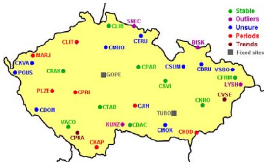
Obr. 6. Sledování krátkodobé stability stanic sítě CZEPOS a dalších permanentních stanic v ČR (autor V. Filler)
